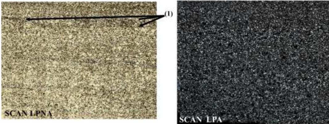
Photo 223 : Scanner d'une lame mince de grès ferrugineux (psammite) constitué de grains de quartz et de micas très fins (60 à 100  $\mu\text{m}$ ). On distingue par endroit (1), que ces grains sont alignés pour former des structures oblique d'origine sédimentaire (voir détails sur la planche 36).
