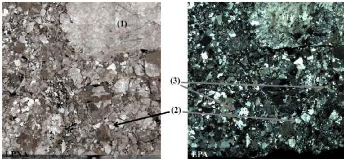
Photo 170 : Microconglomérat constitué de fragments de roche polycristallins : quartzite (1), de grains monocristallins : quartz (2), micas (3), le tout présente une texture jointive.
