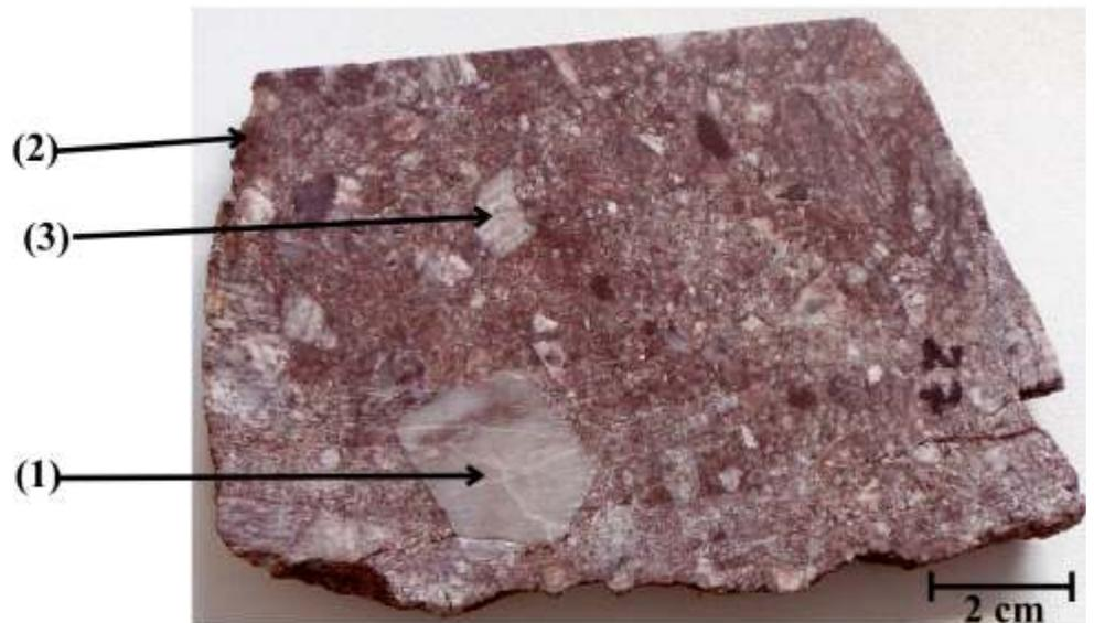
04\_1 : Conglomérat silicoclastique hétérogranulaire faciès des "Vieux Grès Rouges" constitué d'éléments de quartzite (1), de pélite (2), de grès siliceux (3), dans une matrice argilo gréseuse ferrugineuse.
