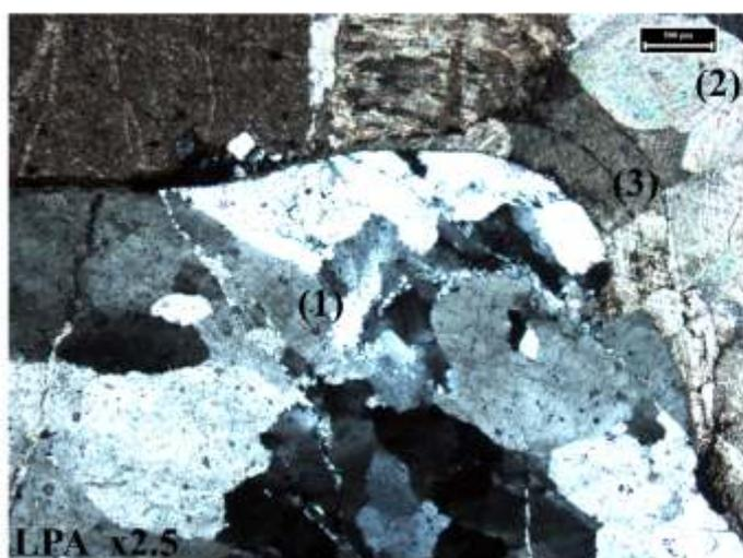
Photo 183 : Élément rudite polycristallin = fragment de quartzite (1) avec un ciment de sparite à la périphérie (2) et des traces d'encroûtement calcaire (3).
