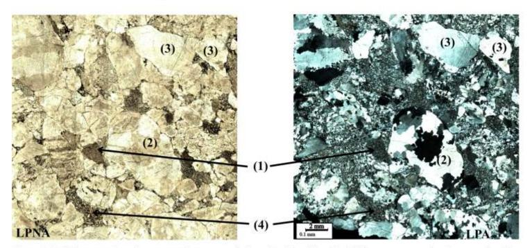
Photo 163: Micro conglomérat grauwacke composés de grains de pellite (1), d'éléments composites de quartzite (2), , de quartz monocristallins (3). La phase de liaison (4) sera analysée plus en détail dans les clichés suivants au fort grossissement.
