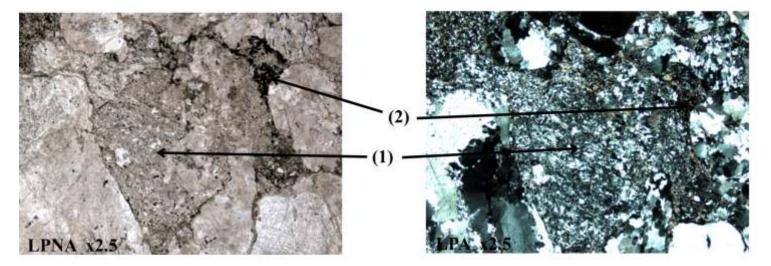
Photo 164: Détail de la photo 163, montrant un espace intergranulaire rempli par une matrice grise assez homogène pouvant être attribuée à de l'argile (1). On observe en outre des éléments (2) noir en LPNA en LPA: c'est du fer.
