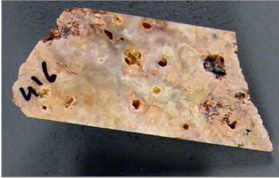
Photo 417 : Surface polie de la zone de prélèvement de la lame mince **416**. On observe de nombreuses vacuoles ou cavernes de dissolution des vestiges de carbonates d'origine. Le test au rouge d'alizarine ne donne pas de coloration, le test à HCl ne donne pas d'effervescence : cette roche ne contient plus de carbonates.
