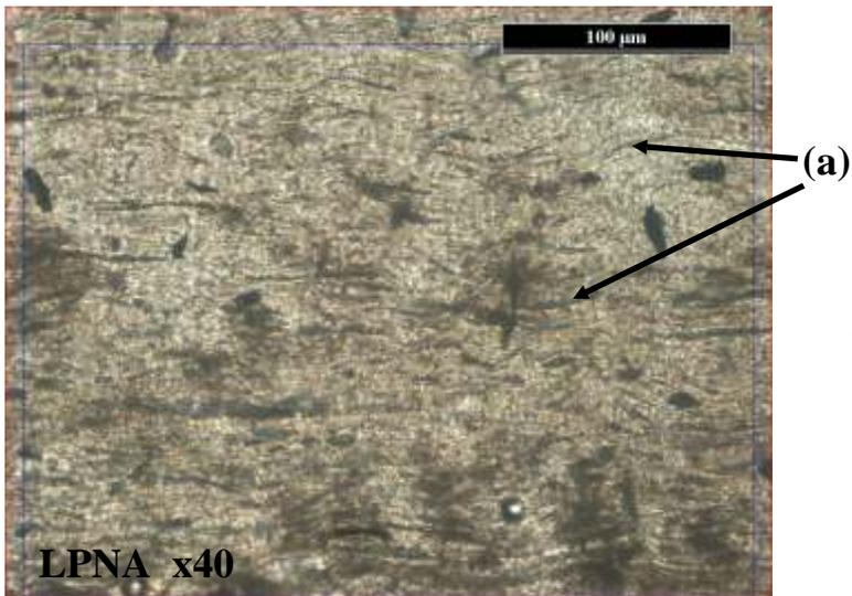
Photo 382 : Détail au très fort grossissement (échantillon **402**) montrant la disposition des débris de frustules (a) ondulés parallèles à la stratification des laminés.
