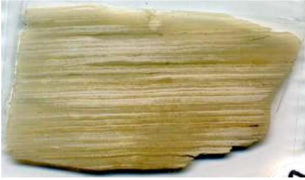
Scanner 379 de la lame mince **402**, montrant les stratifications sédimentaires de la diatomite analysée plus bas.
