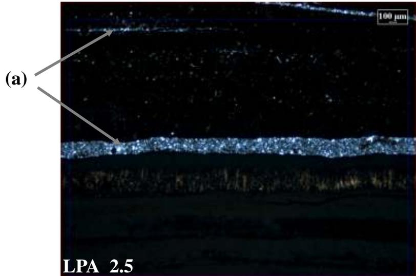
Photo 380 : Lame mince dans une diatomite (**402**) montrant la disposition en laminés sédimentaires. La roche est constituée presque exclusivement d'opale isotrope (extinction) en LPA. Seules ne sont visibles que les fentes de décollement **(a)** remplies secondairement par un ciment de silice en mosaïque reconnaissable à ses teintes de polarisation à faible biréfringence dans les gris en LPA.
