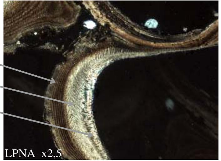
Photo 112 : Détail de la planche précédente montrant la microstructure typique des Gastéropodes, à savoir : (a) une couche externe prismatique, (b) une couche de pseudo prismes entrecroisés, (c) une couche interne ou nacrée lamelleuse.
