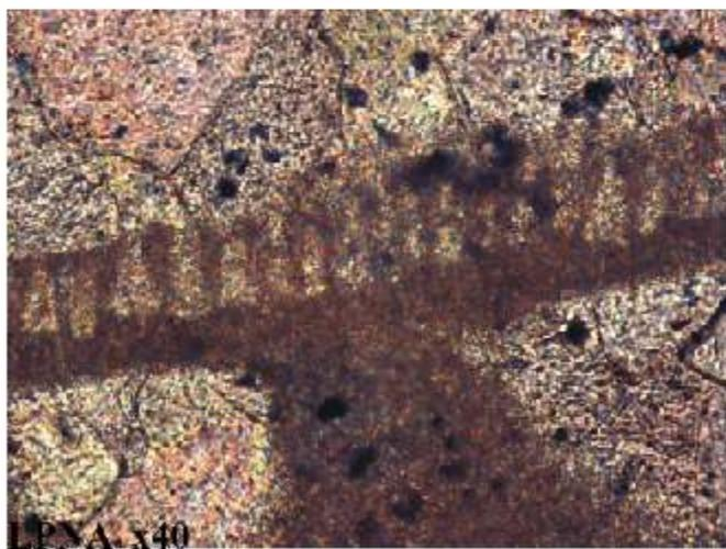
Photo 82 : détail au fort grossissement des photo précédentes montrant la micro structure des *Fusulines* : (a) micro granuleuse représenté par de minuscules micro cristaux granulaires de calcite constituant de petits points scintillants en LPA et (b) pseudo fibreuse constituée par l'alignement de petits prismes de calcite.
