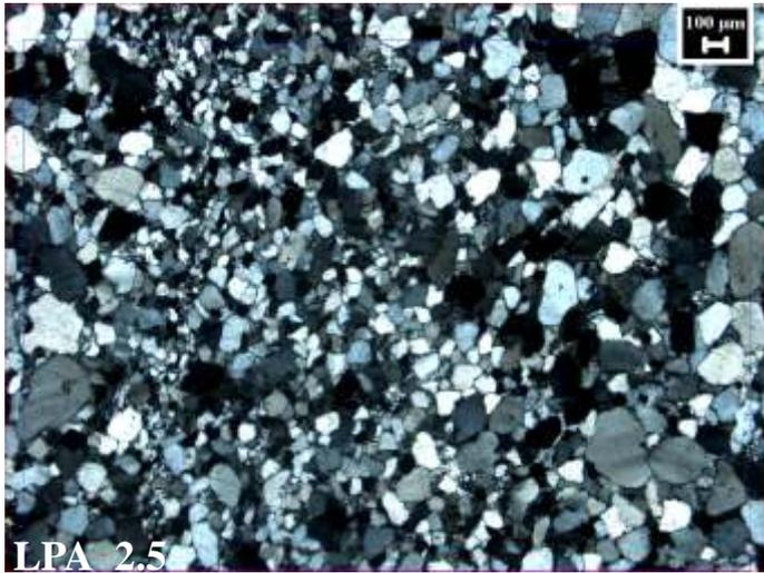
Photo 293 : On constate l'existence d'une zone (**a**) de granulométrie plus fine que le reste de la lame. Ces passées plus fines correspondent aux structures sédimentaires repérées sur le macro échantillon sous forme de stratifications obliques. Le faciès est identiques aux lames 25 et 26 et correspond aux grès dévoniens des Aldudes déjà décrits.
