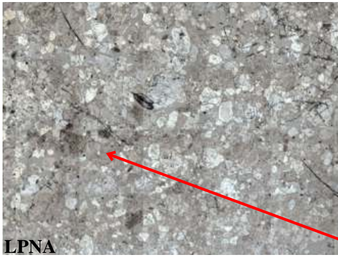
Photo 267 : photo mosaïque d'un grès quartzite constitué en majorité de grain de quartz (1), de petite taille (<100µm), bien classé et présentant une porosité (2) relativement importante.
