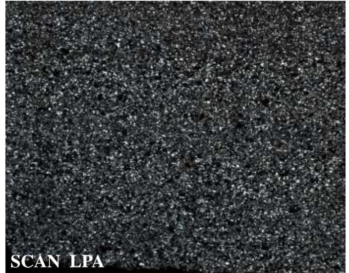
Photo 223 : Scan d'une lame mince de grès ferrugineux constitué de grains de quartz et de micas très fins (60 à 100  $\mu\text{m}$ ). On distingue par endroit (1), que ces grains sont alignés pour former des structures oblique d'origine sédimentaire.
