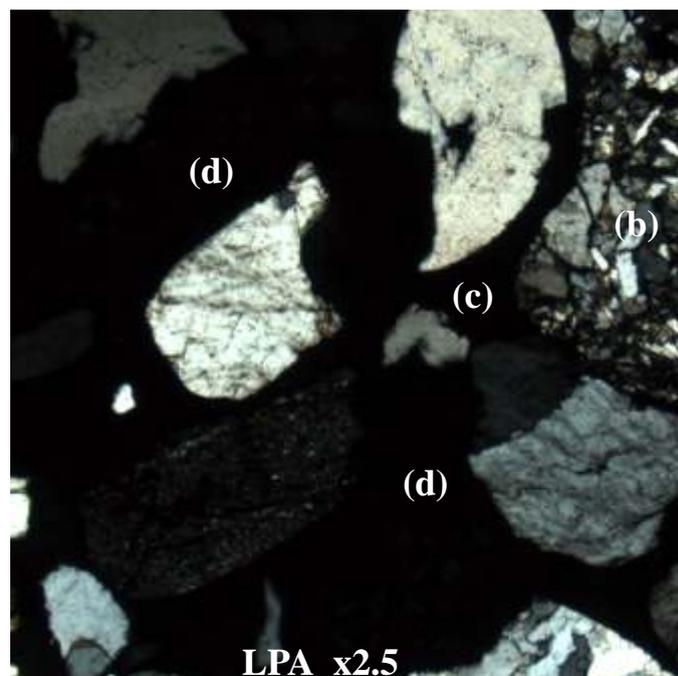
Photo : 196 : Fragment de pellite (a) et fragment de micro grès (b). Remarquer que les espaces inter granulaires sont : soit rempli de ciment d'oxyde de fer (c) opaque sur les deux clichés, soit de résine isotrope (d) (claire en LPNA éteinte en LPA) et emprisonnant des bulles d'air (e).
