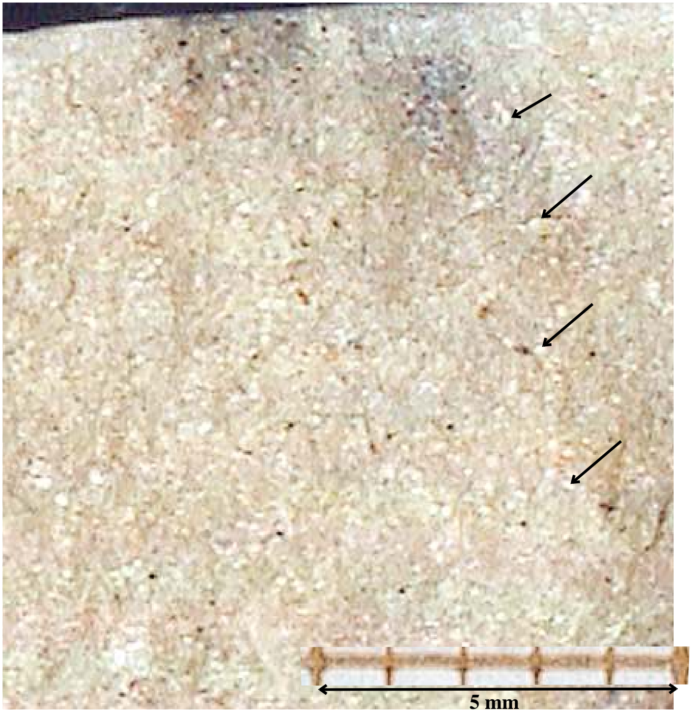
20_2 : Grès quartzite (x 20). Les plans de section des grains de quartz apparaissent sous forme de plages brillantes
