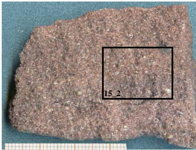
**15\_1 : Grès rouge dits “vosgien” : cimentation peu poussée : les grains de quartz apparaissent nettement en relief.**
